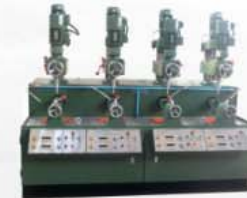
QTMJ-80型 四头球体研磨机 Four-headed Ball Grinding Machine of Model QTMJ-80
